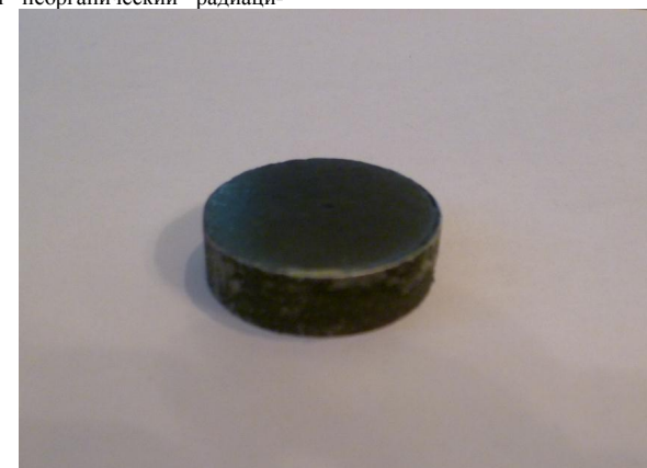
Рисунок 1. Внешний вид лабораторного образца высококонструкционного неорганического радиационно-защитного металлокомпозиционного материала на основе высокодисперсного железоксидного наполнителя (гематита \text{Fe}_2\text{O}_3 ), оксида висмута и дюралевой матрицы
